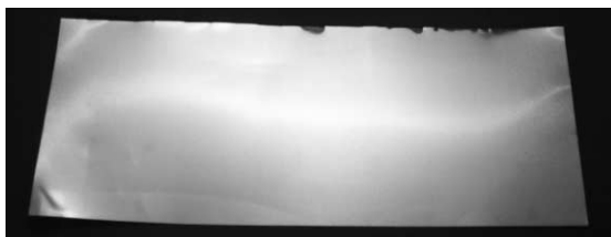
写真7 シリンダー用のアルミ板を300mm×200mmにカットする。金属板カット用のハサミを使うと作業が楽
