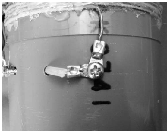
写真29-3 3D-2Vの芯線側を右から2番目の穴から出して、同じように圧着端子を取り付ける
