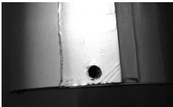
写真17-1 固定シリンダーが重なった部分に4mmの穴を電動ドリルであける
