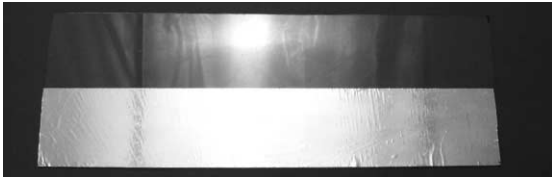
写真15 塩ビ・シートと固定シリンダーが接触する部分にアルミ・テープを張る
