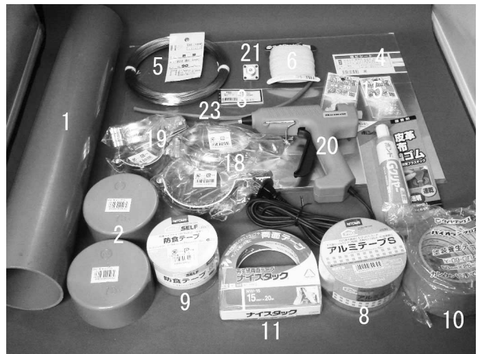
写真2 今回の7MHz用スーパー・ラド・アンテナ製作に使用する材料（一部を除く）
