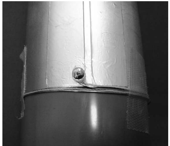
写真21 水系と銅線を一緒に巻き、ビスの下側まで来たところで1ターンになる
