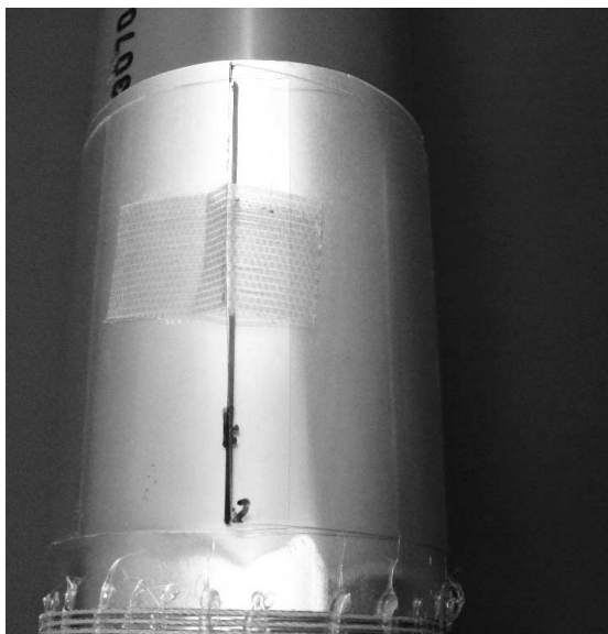
写真14 カットした塩ビ・シートを固定シリンダーの上から 巻きつけて、余分な部分に印を付けてカットする
