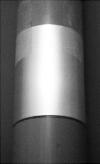
写真9 塩ビ・パイプに付けた25cmの位置にアルミ板を合わせて仮に巻く
