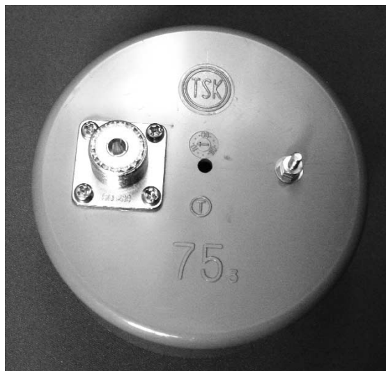
写真27 MJの座とアース用端子を取り付ける
